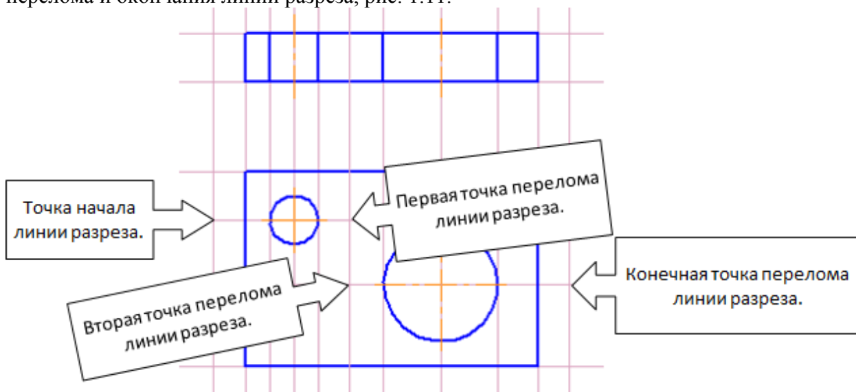
Рис. 10.11- Вспомогательные прямые образующие точки начала, перелома и окончания линии разреза.
